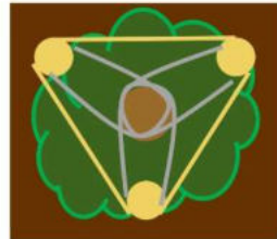
Schéma de sanglage sur tuteurage tripode
